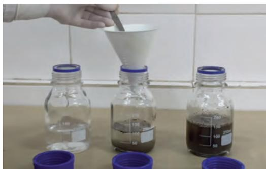
**Figura 3.5.** Preparación de un extracto suelo:agua 1:2 (método holandés), por adición de un volumen de suelo a humedad de campo a dos volúmenes de agua, de tal forma que el volumen total se incremente en una parte.
