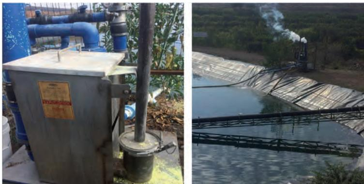
Figura 10.6. Quemador de azufre instalado en un reservorio.
