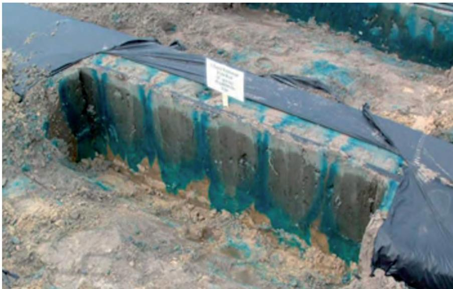
**Figura 2.4.** Forma del bulbo húmedo en una instalación de riego por goteo. Foto cortesía UF/IFAS.
