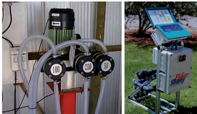
Figura 9.7. Modelos de inyectores de fertilizantes automáticos.
