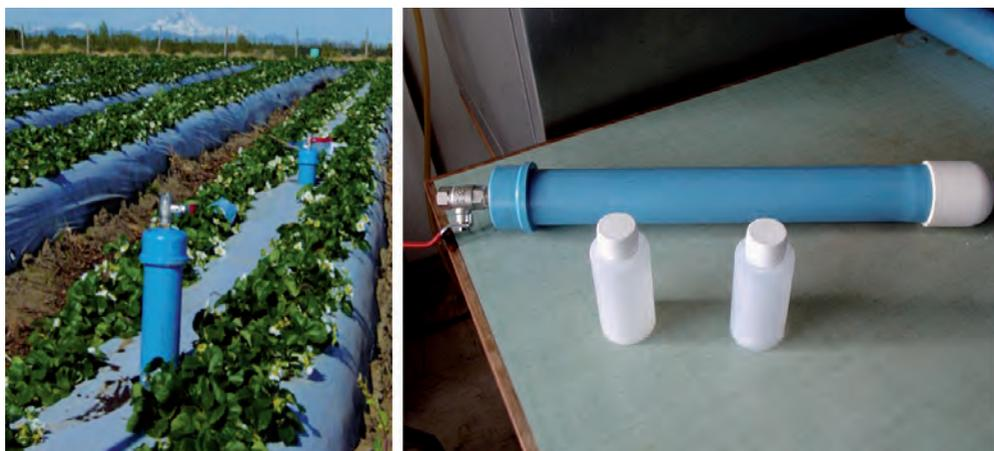
**Figura 3.4.** Sondas de succión instalados en cultivo de fresas para extraer solución de suelo y, posteriormente, analizar las concentraciones de nutrientes del suelo, pH y CE.
