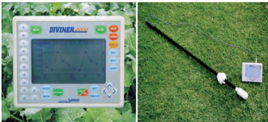
Figura 12.4. Sondas de capacitancia portátiles (FDR).
