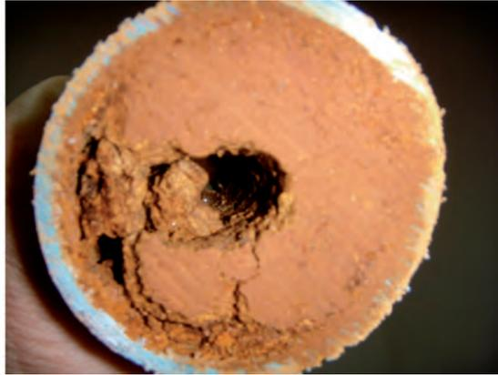
**Figura 10.3.** Precipitado de  $\text{Fe}(\text{OH})_3$  (hidróxido férrico) en tubería de riego de un huerto de kiwi de la comuna de Quillón, Chile.
