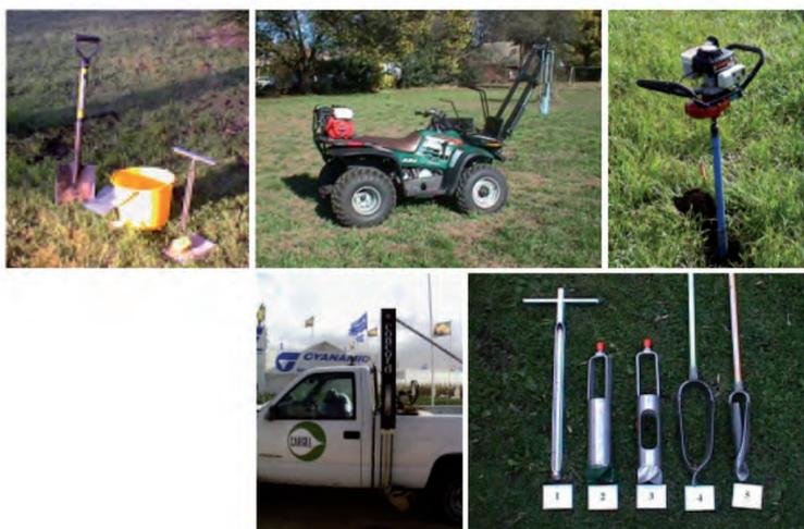
**Figura 3.1.** Diversos equipamientos para muestreo de suelos.
