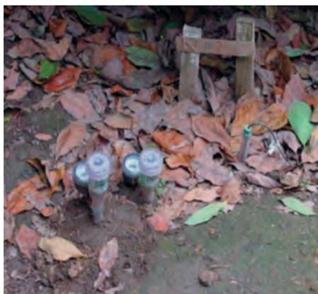
Figura 12.2. Tensiómetros instalados en aguacate.
